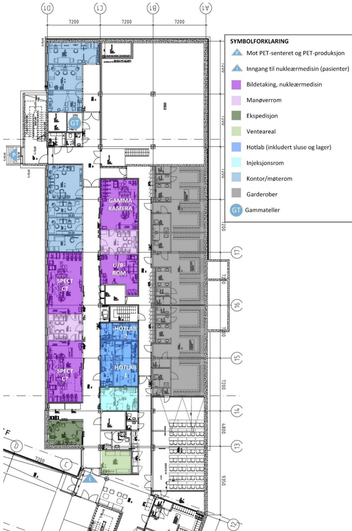
Figur 9.15 Illustrasjon – SPECT CT ved St. Olavs hospital, områder og arealer (Kilde: Madsø Sveen arkitekter AS; tilrettelagt av Sykehusbygg HF)
