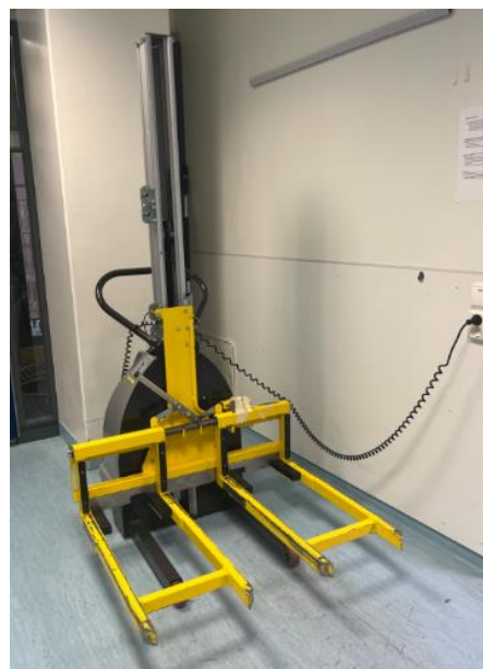
Bilde 18: Liften som brukes for av- og pålossing av innervogner på AGV-vogner, Foto: Privat, tatt på St. Olavs
