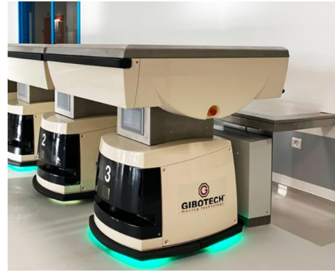
Bilde 16: Mindre AGV som transporterer innsatser med medisinsk utstyr (Larsen, 2022).
